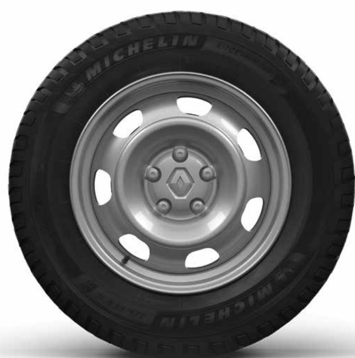
rin de 16" de acero estampado con pintura color plata
